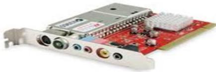
TV Tuner merupakan perangkat yang memungkinkan komputer untuk menangkap siaran televisi dan menampilkannya pada layar monitor. TV Tuner biasanya berupa kartu (card) yang dipasang pada card expansion. Tapi ada juga TV Tuner External yang dipasang di luar komputer, bahkan bisa langsung dihubungkan ke monitor.
