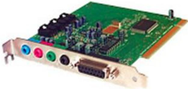
Sound card (kartu suara) adalah perangkat yang terhubung pada papan induk (motherboard) yang berfungsi sebagai alat untuk mengolah dan mnegontrol suara, baik suara yang masuk (merekam) dan suara yang keluar melalui speaker. Hal ini dimungkinkan karena pada sound card terdapat masukan (Line in, Mic dan MIDI) serta keluaran (line out/speaker out).
